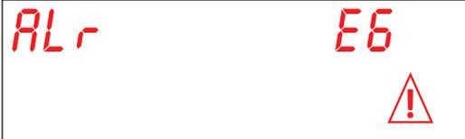
**E6. TANK DRAINING FAILED:**
