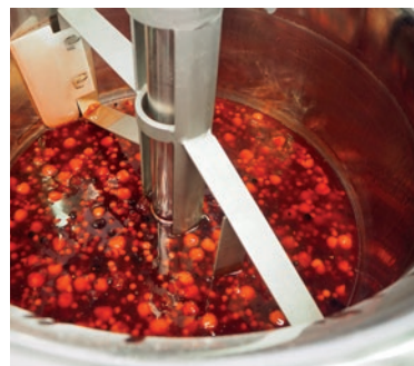
Kraftig, underhållsfri, autoreverserande omrörare för all typ av blandning, inklusive vispning. Finns även som extra kraftig version för särskilt krävande belastningar
