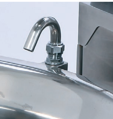
Vedentäyttöhana padan reunalla toimii myös kallistettaessa.
