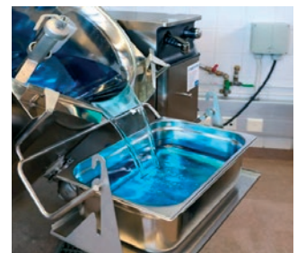
Kaatotaso GN-astioille, keinukiinnitys
