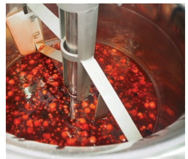
Vahva, huoltovapaa, kahteen suuntaan pyörivä monitoimisekoitin kaikkeen sekoitukseen, myös vispaus. Saatavana myös Heavy duty -sekoitin vielä raskaampaan käyttöön.
