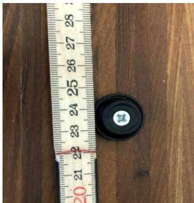
**4B** Telineiden kiinnittäminen seinään: Kiinnitä ensimmäinen jalka lattiaan täsmälleen 225 mm seinästä
