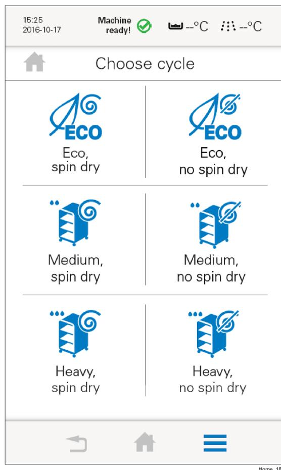
Lorsque la machine est prête à laver, les programmes suivants s'affichent sur le panneau de commande à écran tactile.
