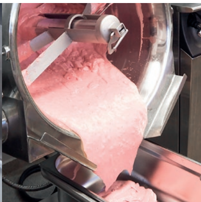
Kallistuskorkeus 600 mm. Pata on ergonominen ja helppo tyhjentää.
